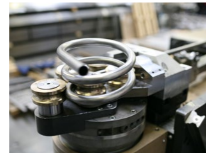
Gięcie profili stalowych
